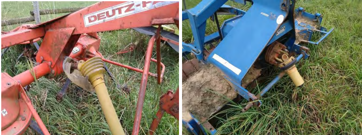
Abbildung 3: Defekte Schutzeinrichtungen durch falsche Lagerung (Quelle: eigene Aufnahme)
