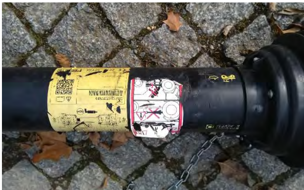
Abbildung 20: Beispiel für eine wenig dauerhafte Kennzeichnung (Quelle: eigene Aufnahme)
