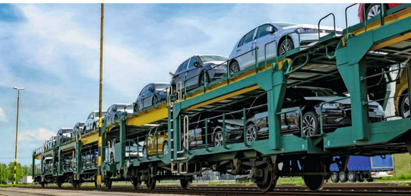
Otwarty wagon do transportu samochodów z dwiema platformami załadunkowymi i poręczą na wysokości 60 cm
