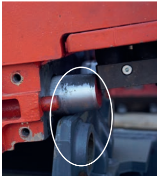
Verrouillage incorrect: axes en dehors des trous
