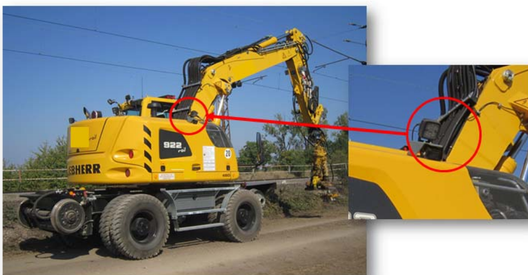
Sicht an Baggern nach rechts
